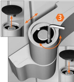
Kappe entfernen. Durch Drehen der Spindel am oberen Banteil Horizontalverstellung vornehmen ( $\pm 2,5$  mm). Kappe aufstecken.
