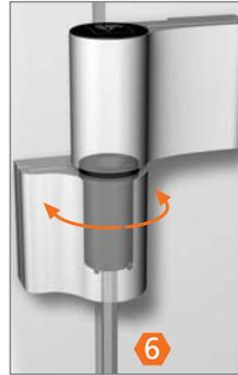
Lagerbuche um  $\pm 90^\circ$  drehen bis sie spürbar einrastet (Dichtungsdruck  $\pm 0,5$  mm)
