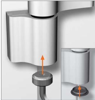
Hebespindel wieder einschrauben. Kappe aufsetzen.
