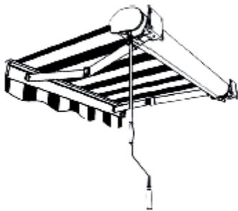
13) Prüfen Sie mit Hilfe der Wasserwaage, ob die Gelenkarme in einer Ebene zueinander schließen. Sollten Sie Einstellungen an den Gelenkarmen oder dem Neigungswinkel vornehmen, muss eine Person die Gelenkarme durch leichtes Nach-Oben Drücken entlasten.
