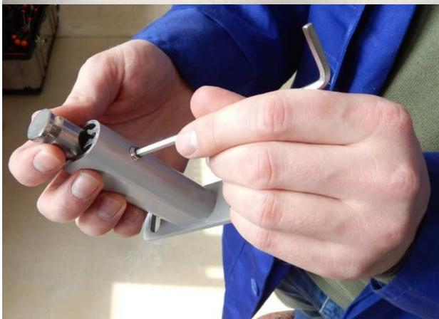
2. Ziehen Sie den Bolzen heraus und Arretieren ihn durch Anziehen der Feststellschraube.
