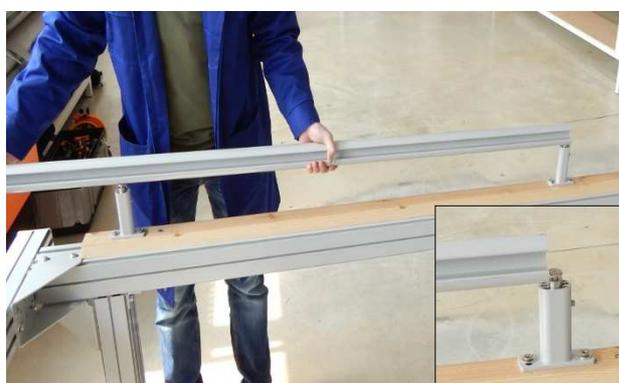
1. Nach Befestigung der Halter gehen Sie zur Montage der Führungsschiene über. Schieben Sie die Führungsschiene über die Bolzen. Nach Einstellung der entsprechenden Position ziehen Sie die Feststellschraube in den Haltern fest. (Abb. 1 und 2).
