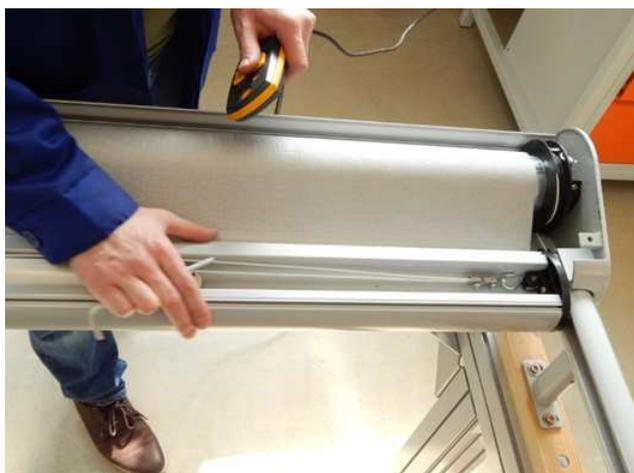
8. Rollen Sie das Tuch maximal auf dem Wickelrohr auf.
