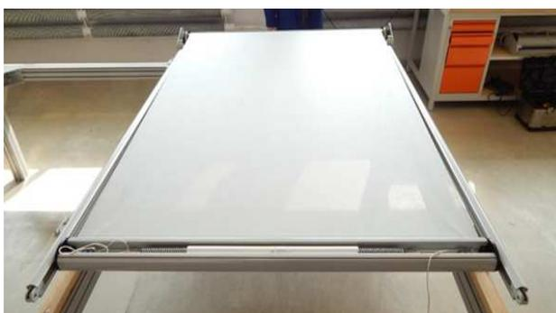
13. Entrollen Sie das Tuch maximal und wickeln es dann wieder auf, damit die einzelnen Systemelemente sich richtig einstellen und anpassen. Prüfen Sie erneut die Federspannung und führen eventuell Anpassungen durch.
